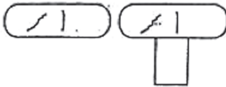
รูปที่ 1 แสดงภาพการแตกร้าวที่ผิวในกระบวนการตีขึ้นรูป
