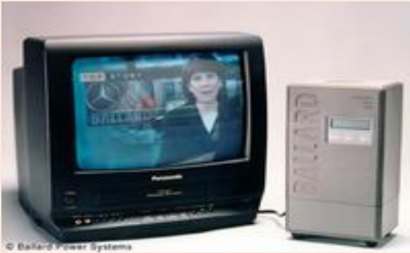
ต้นแบบเซลล์เชื้อเพลิงแบบพกพาขนาด ๑๐๐ วัตต์ กำลังจ่ายพลังงานให้กับโทรทัศน์และเครื่องเล่นวีดีโอ
