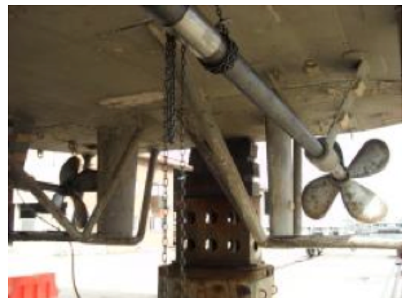
ข) เพลลาใบจักรของเรือหลวงทองหลาง
