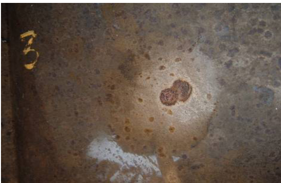
2 สภาพความเสียหายและการเกิด Dealuminification ของใบจักรแบบ VSP ครั้งที่ 1
