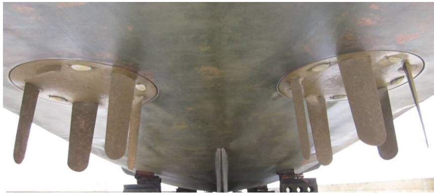
1 ใบจักรแบบ VSP ของเรือหลวงลาดหญ้า
