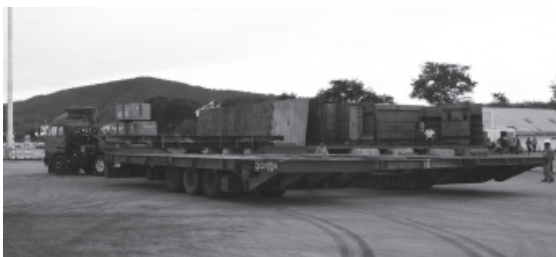
รูปที่ 5 รถขนต่ำที่ดัดแปลงให้มีขนาดกว้าง 10 เมตร เพื่อใช้ในการย้ายบล็อก
