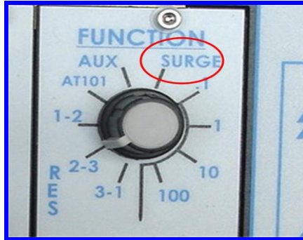
รูปที่ 11 แสดงการเลือก FUNCTION KNOB ไปที่ SURGE
