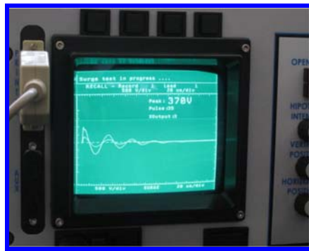
รูปที่ 15 แสดงการเลือก LEAD 1 เป็นกราฟอ้างอิง
