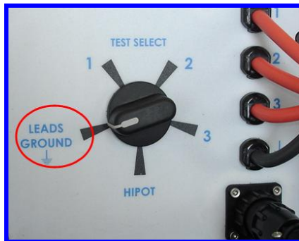
รูปที่ 16 แสดงการเลือก TEST SELECT ไปที่ GROUND
