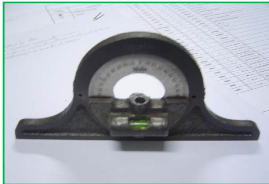
ภาพที่ ๓ แสดงเครื่องมือวัดมุมแบบวางทาบ
