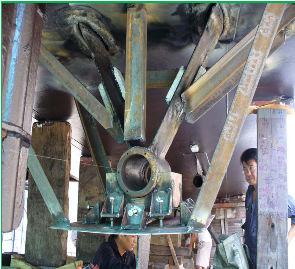
ภาพที่ ๗ แสดงการติดตั้ง Adjusting Screw สำหรับปรับแต่งโยงโย่
