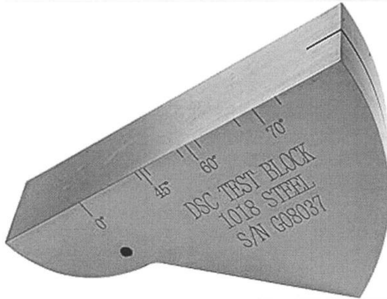
รูป ก-13 แท่งปรับระยะ และความไวมาตรฐานชนิด Distance and Sensitivity Calibration Block (DSC)
